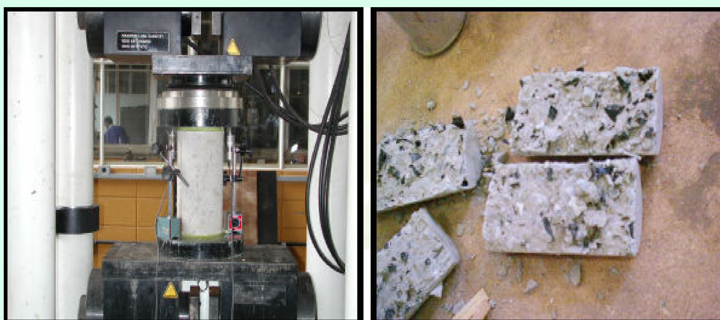
Figura 1 - Ensaio de ruptura em corpo de prova Fonte; Instituto Via Viva, 2004.
