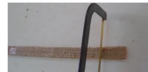
Figura 5: Tecido de fibra de sisal sendo serrada para que não haja tração proporcionada pela máquina.
