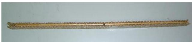
Figura 4: Disposição dos filetes de madeira cobertos pelos tecidos de sisal. Corpo de prova.
