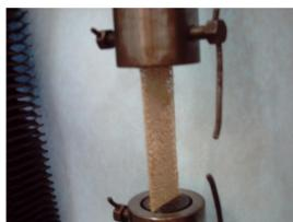
Figura 2: Corpo de prova sendo tracionado durante o ensaio.
