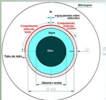
Figura 2 - Desenho da sonda com blindagem e eletrodos fonte e sensor na parte superior. Blindagem externa de chapa de alumínio que o campo da sonda internamente e protege a sonda do efeito de campos elétricos externos.
