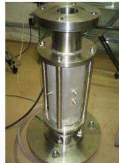
Figura 5 - Sonda acoplada à base de calibração estática. Esta foto é a representação real do desenho exposto na figura 3 acima.
