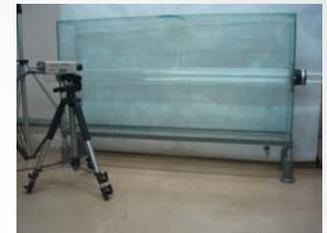
Figura 6 - Visor e câmera para observação das características do escoamento
