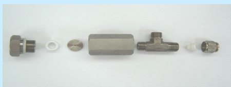
Fig. 1: Montagem da válvula J-T. O disco com furo de 0,3 mm de diâmetro é colocado dentro de um porta filtro para ser anexado adequadamente ao sistema.
