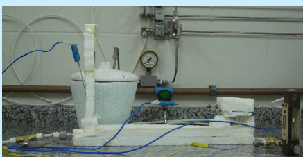
Fig. 2: Sistema operando com H 2 passando por N 2 líquido para reduzir a temperatura do gás antes da expansão (acima).
