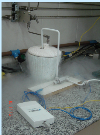
Fig. 2: Sistema operando com H 2 passando por N 2 líquido para reduzir a temperatura do gás antes da expansão (acima).
