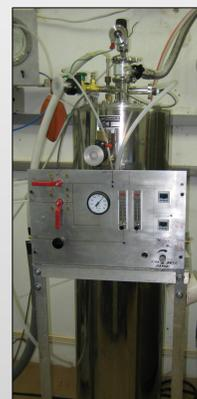
Fig. 6 - Criostato Janis com o sistema por fluxo de gás já inserido e calorímetro montado.
