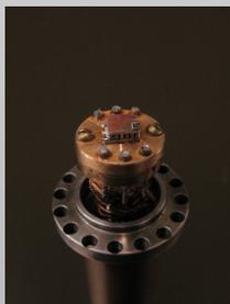
Fig. 2 – Montagem aberta com a “cabeça” presa e contatos elétricos prontos. Vemos colados sobre a cabeça o elemento peltier, sensor cernox e o resistor SMD.
