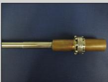
Fig. 1 – Vista do calorímetro montado. O tubo de inox serve de suporte mecânico e para a passagem da fiação sob vácuo. A flange foi feita em inox para permitir a limpeza do anel de vedação de indio, sem danos.
