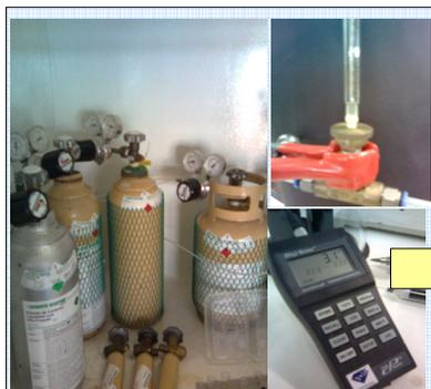
Cilindros com gases utilizados na mistura e sistema para injeção de vapor de água.
