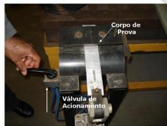
O corpo de prova é fixado de maneira que garanta a deformação em apenas um sentido.
