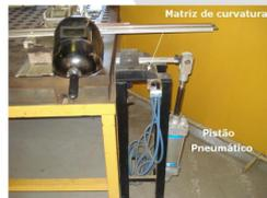
O raio de curvatura da matriz irá determinar a tensão imposta sobre o corpo de prova.
