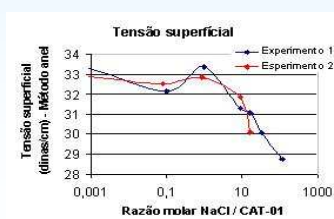
Figuras 3 e 4: Variação da tensão superficial devido ao desproporcionamento com SDS (3) e NaCl (4)
