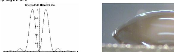
Fig. 4- Modelo proposto para o fenômeno de franjas claras e escuras, segundo a teoria de difração de Fraunhofer. À direita temos o formato de lentilha da gota que origina o gráfico.
