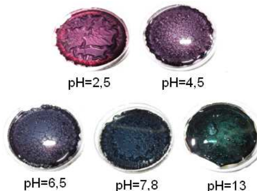
Figura 2: Resposta colorimétrica dos filmes inteligentes imersos em soluções tampão com diferentes pHs.
