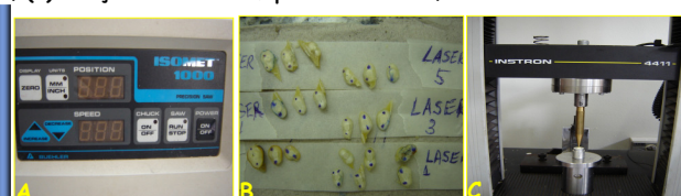
Fig. 4 - (A) Painel de controle da máquina de corte Isomet; (B) Discos ( slices ) obtidos pelos cortes na Isomet; (C) Corpo-de-prova na máquina Instron para realização do teste de push-out .
