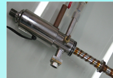
Figura 5- Vista frontal da base do sistema de dedo frio. A temperatura da base é mantida constante, o heater fornece energia para o sistema e o Peltier nos dá diferença de temperatura entre o sistema e a amostra.
