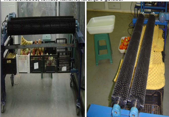
Figura 1 e 2. Equipamento de classificação: vista lateral (posicionamento das caixas de classificação) e de topo (escovas divergentes).
