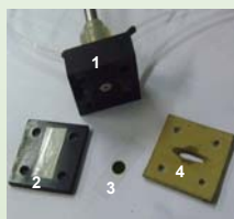
Fig. 2. Foto da cela desmontada, (1) fibra óptica bifurcada, (2) fita reflexiva, (3) membrana sensora, (4) espaçador de borracha.
