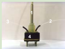
Fig. 4 Foto da cela utilizada, (1) fibra óptica, (2) entrada de solução, (3) saída de solução, (4) local no qual a membrana está acomodada
