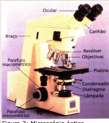
Figura 3: Microscópio óptico
