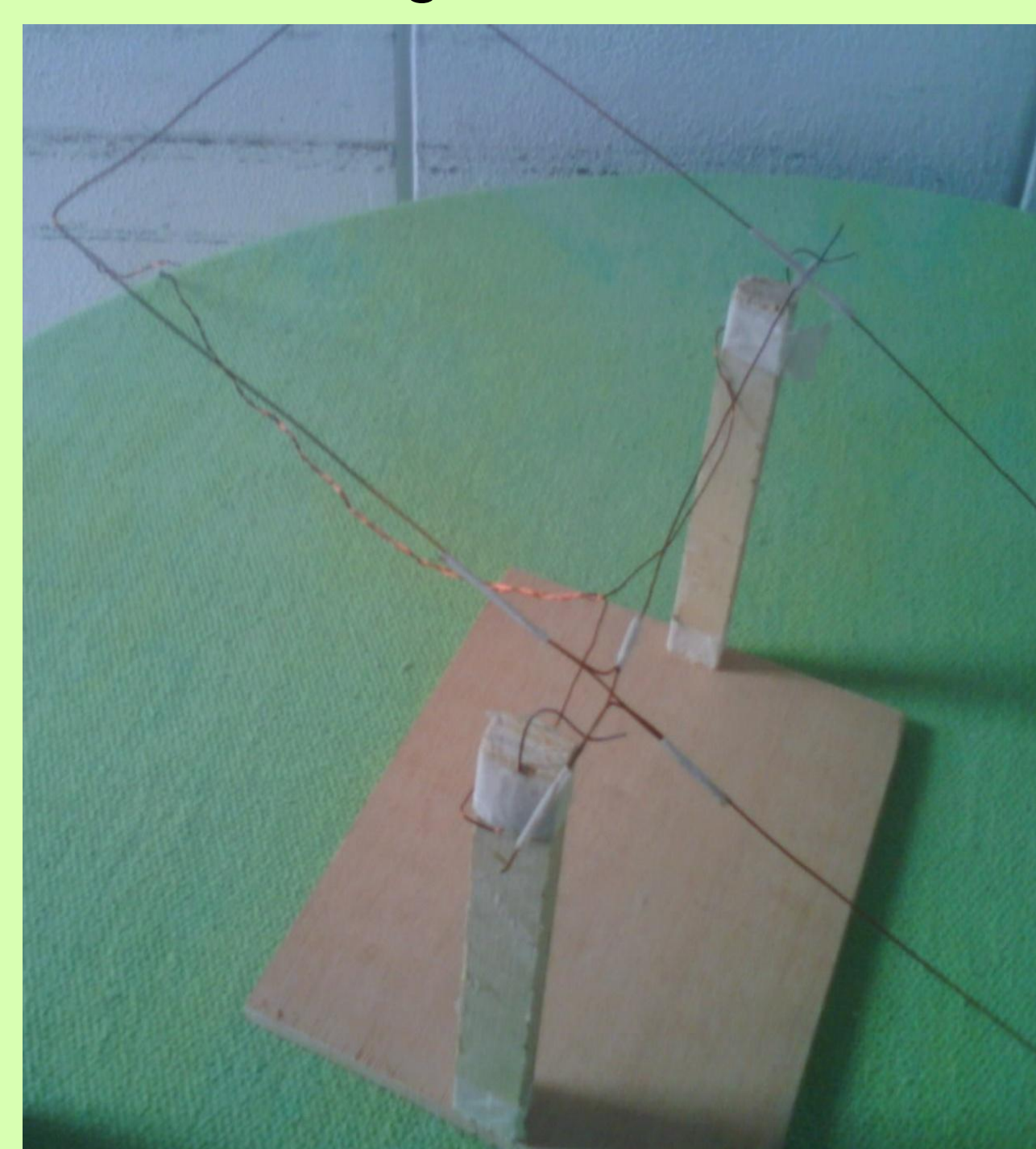
Figura 6: Espira de inclinação reagindo ao magnetismo terrestre.
