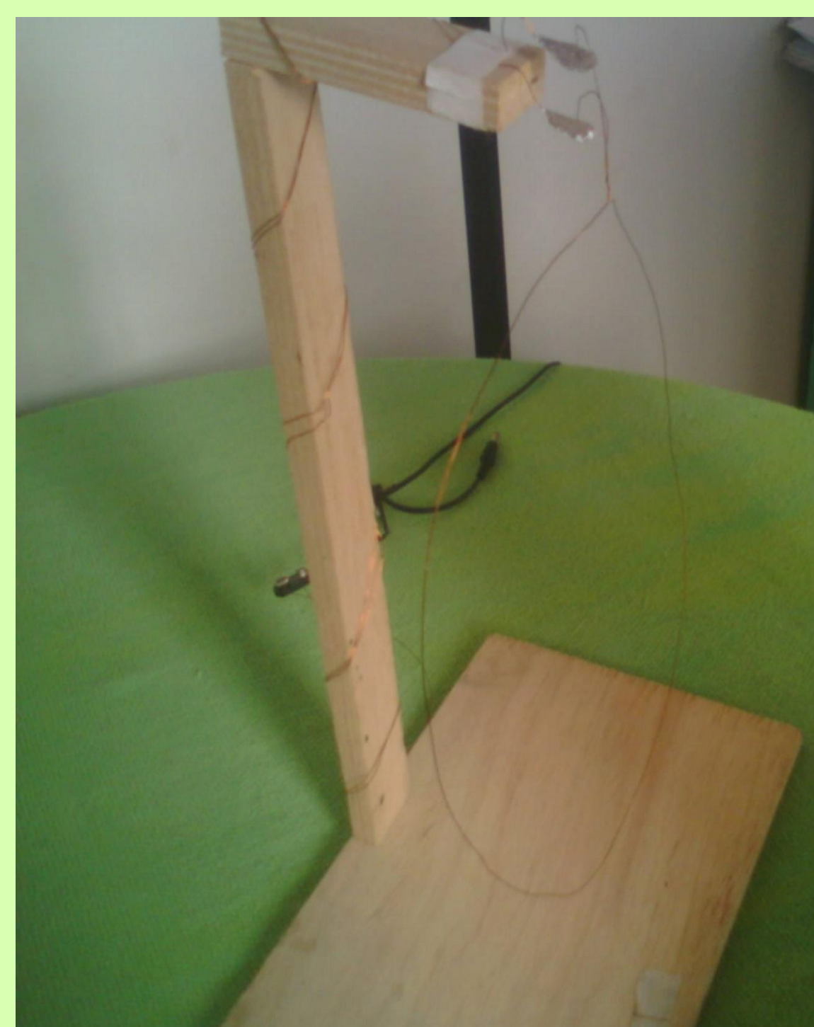
Figura 5: Espira com corrente reagindo ao magnetismo terrestre.
