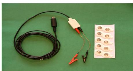
Figura 2: Eletrodos de superfície
