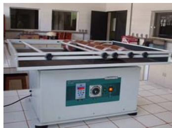
FIGURA 1: Vista da mesa agitadora recíprocante de baixa rotação utilizada na análise granulométrica no LABSOL – FEAGRI.
