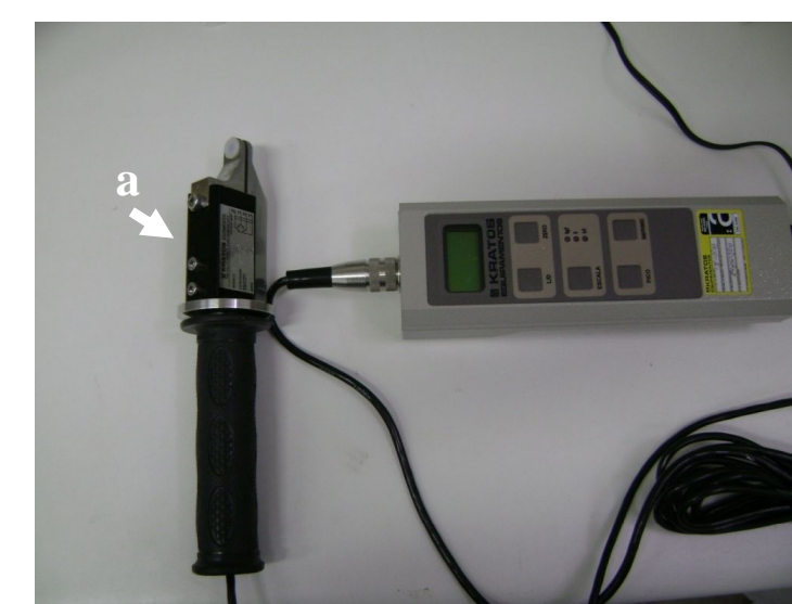
Figura 3 – Gnatodinamômetro Digital – (A) Forquilha e (B) Aparelho digital.
