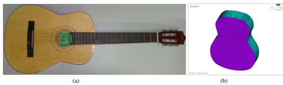
Fig. 02 – Aspecto geral: (a) violão comercial; e (b) modelo da caixa acústica no MEF.
