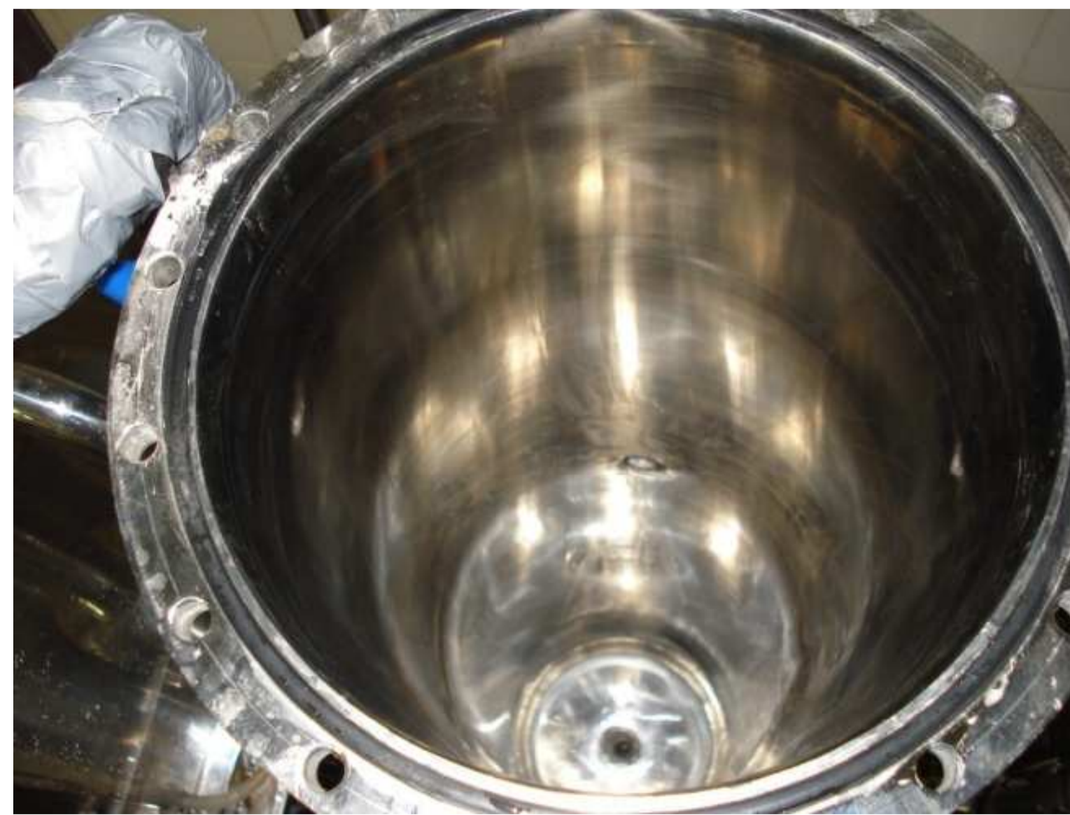
Figura 3. Contaminação na câmara de carbonatação.
