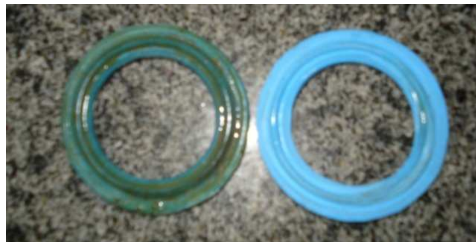
Figura 2. Contaminação no o-ring.
