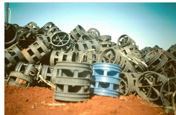
Figuras 4 e 5 – Fotos do Meio Suporte (oring) que é utilizado como enchimento do Filtro Anaeróbio
