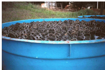
Figuras 4 e 5 – Fotos do Meio Suporte (oring) que é utilizado como enchimento do Filtro Anaeróbio
