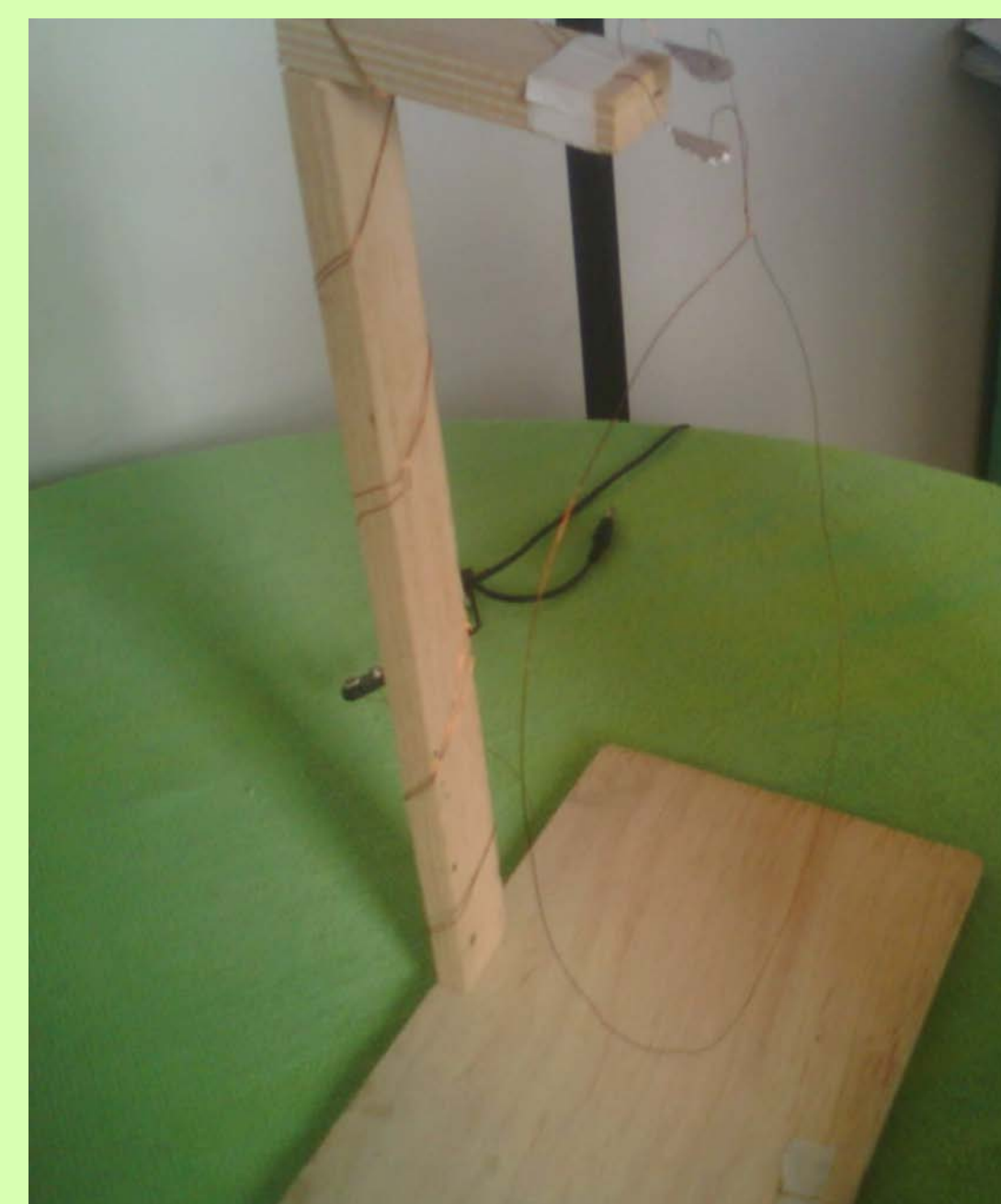
Figura 5: Espira com corrente reagindo ao magnetismo terrestre.
