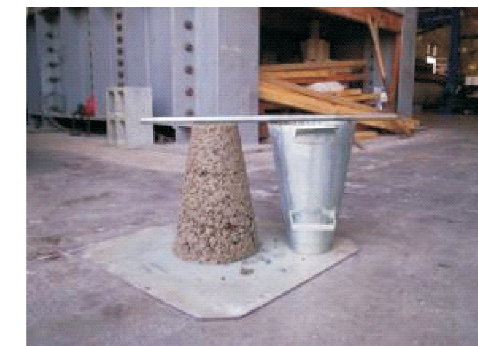
Figura 6 – Slump-test do concreto sem isolador
