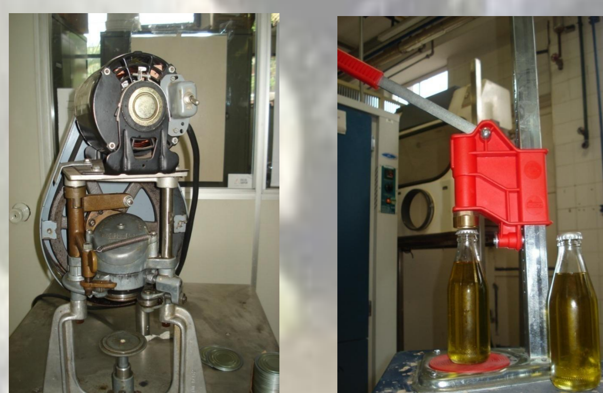
Figura 1. Recravadeira manual e fechador de rolha metálica tipo coroa.
