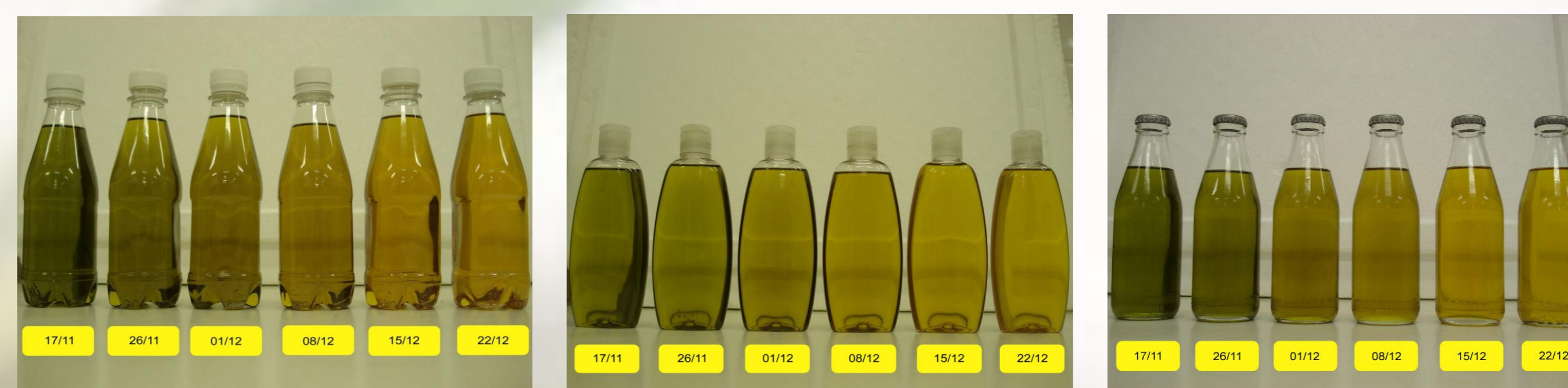
Figura 2. Amostras acondicionadas em embalagem PET transparente, PET com absorvedor de radiação ultravioleta (UV) e vidro, respectivamente.
