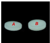
Discos de Empress Esthetic®: A - 1,4 mm e B - 2 mm
