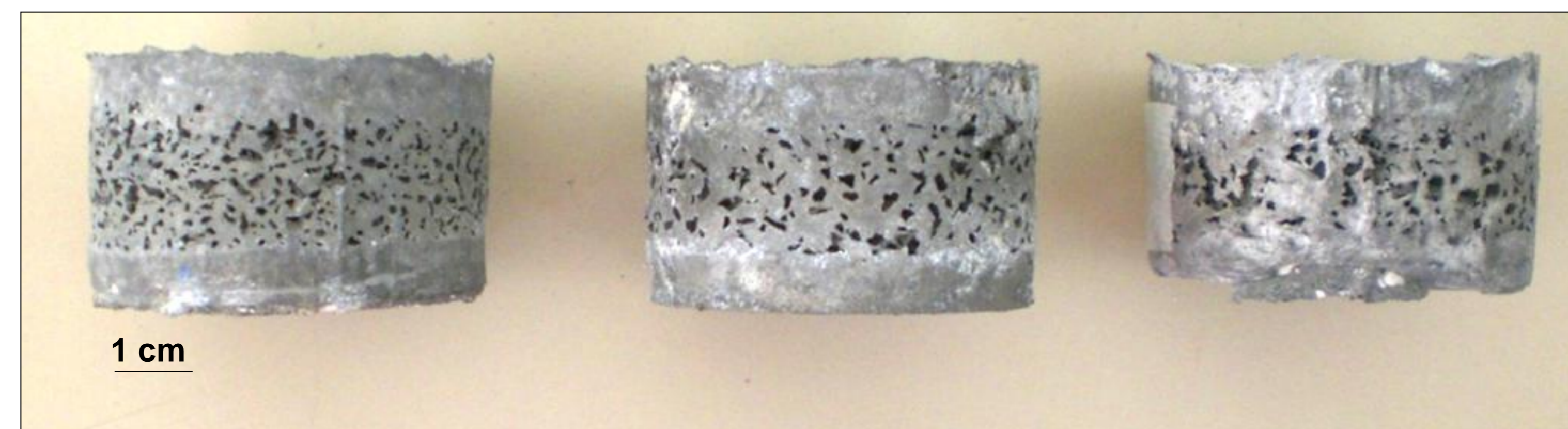
Fig. 1. Esponjas de AA2011 obtidas por tixoinfiltração em pré-formas de NaCl.
