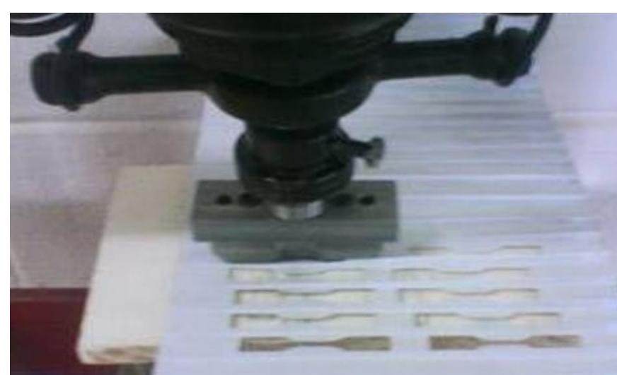
Figura 4. Corte de corpos de prova.
