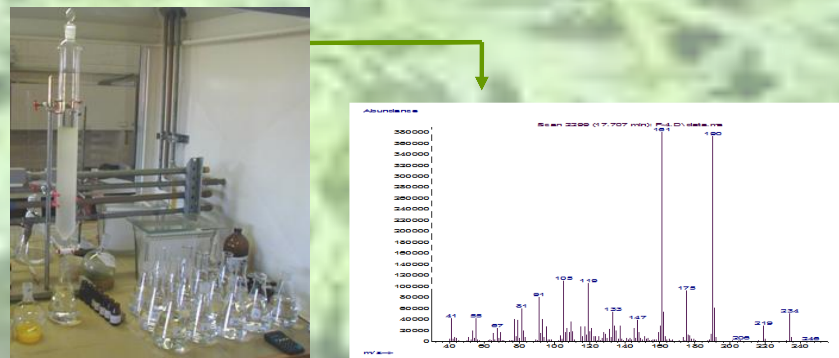
Figura 4: Esquema de obtenção e isolamento do composto dihidroepideoxiartenuína-b, a partir da fração enriquecida em lactonas sesquiterpênicas (FLAC) por métodos cromatográficos
