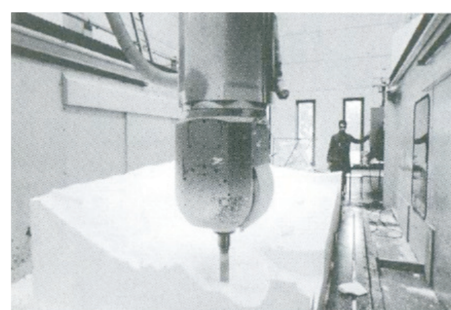
Usinagem na CNC através do arquivo CAD
