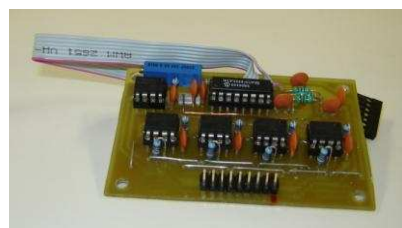
Condicionamento de sinais
