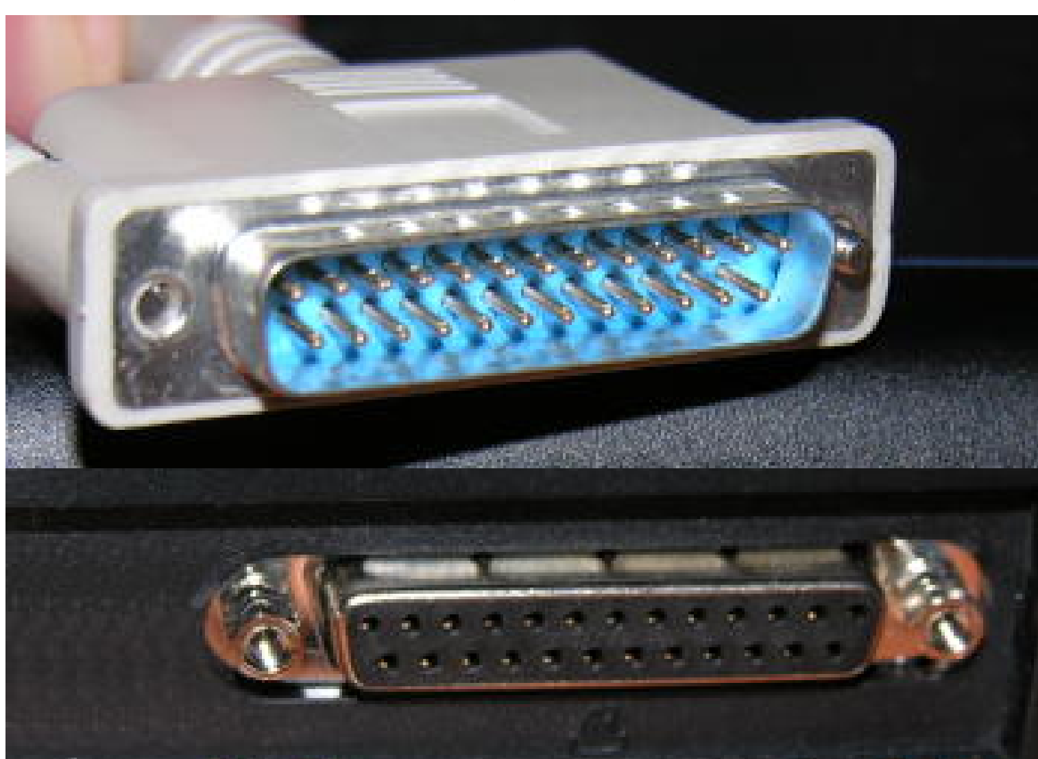
Fig 2: Detalhe dos conectores macho e fêmea da porta paralela.
