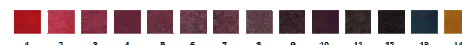
Figura 4. Escala de cores para pH do papel indicador com extrato de ACYS de jussara
