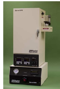
Figura 2. Equipamento para extração supercrítica sem uso de co-solvente (Spe-ed SFE, Applied Separations)
