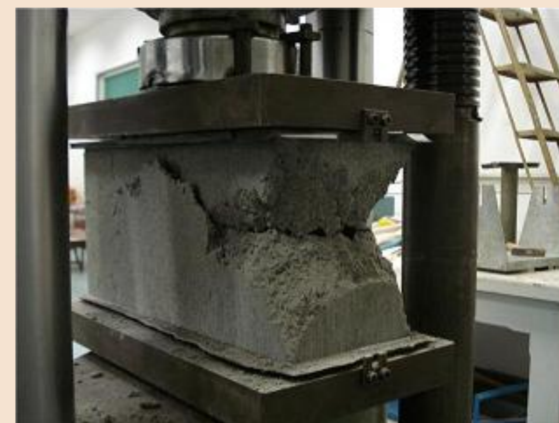
Figura 3 – Ensaio de compressão dos blocos de concreto
