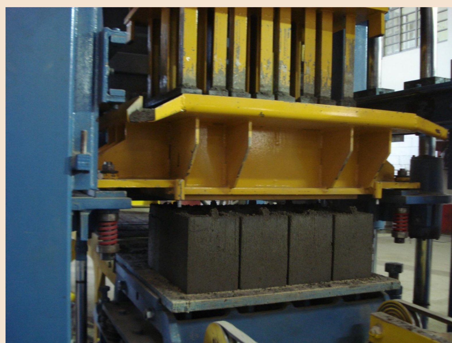
Figura 2 – Moldagem dos blocos de concreto
