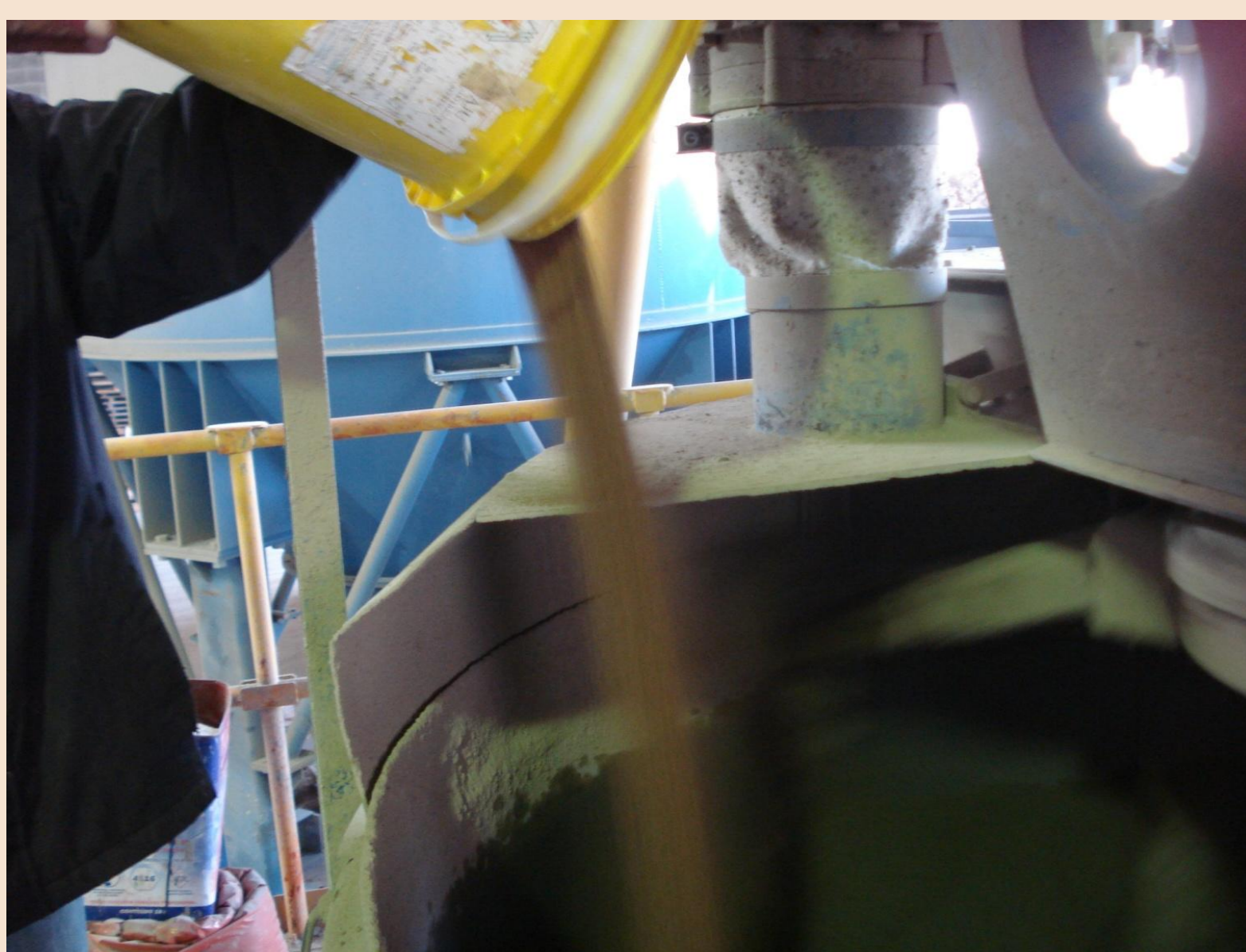
Figura 1 – Adição de lodo de ETA no concreto
