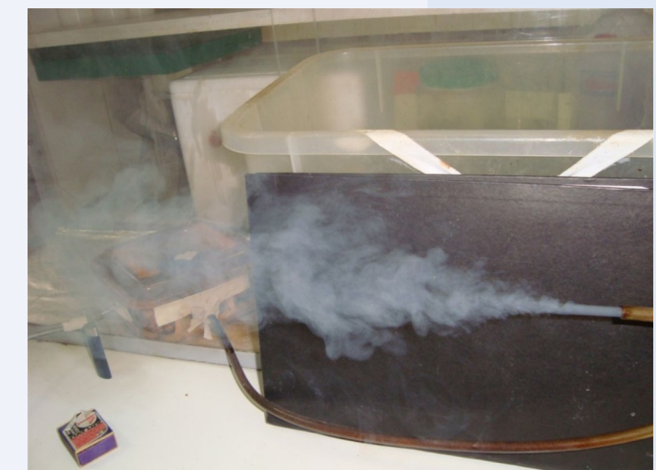
Imagem 2 - Fluxo de fumaça obtido com 10 litros/min de fluxo de ar comprimido.
