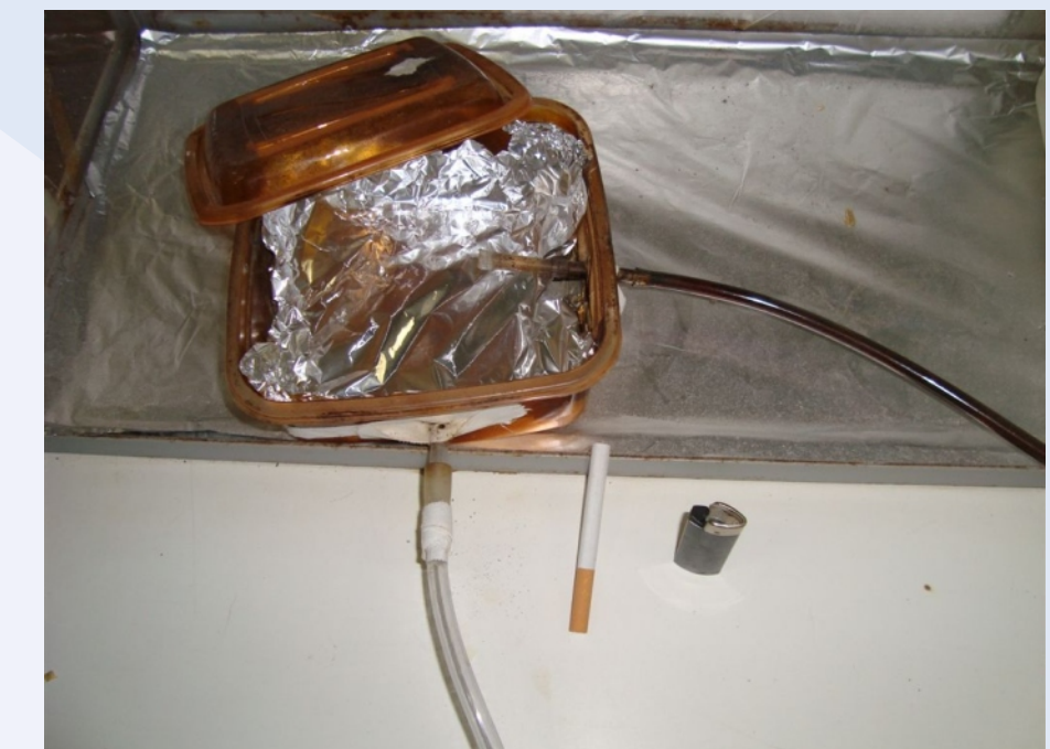
Imagem 1 - Detalhe: Câmara pressurizada de queima do cigarro.
