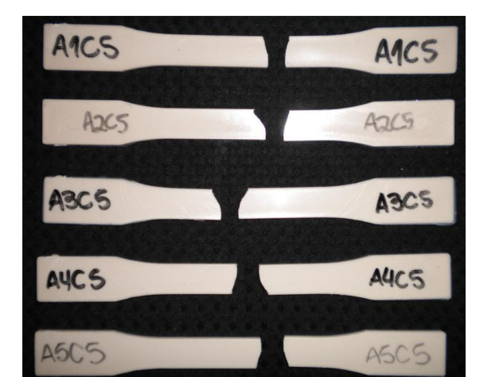
Fig. 5 – Corpos de Prova dos Nanocompósitos após Ensaio de Tração.
