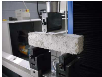
Figura 2: ensaio de tração na flexão
