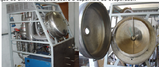
Figura 2. Protótipo de Destilador Molecular Centrífugo. Detalhe da área do evaporador e condensador.
