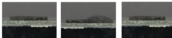
Figura 2: Ângulo de contato com a) água, b) glicerol e c) diiodometano.
