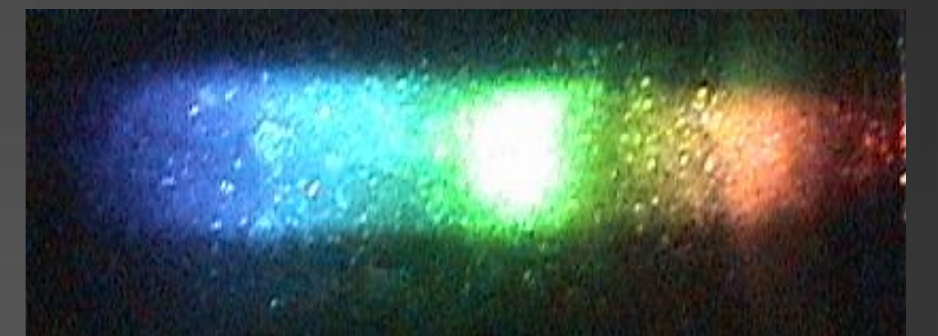
Figura 05: Espectro gerado pela rede de difração focalizado na DCG.
