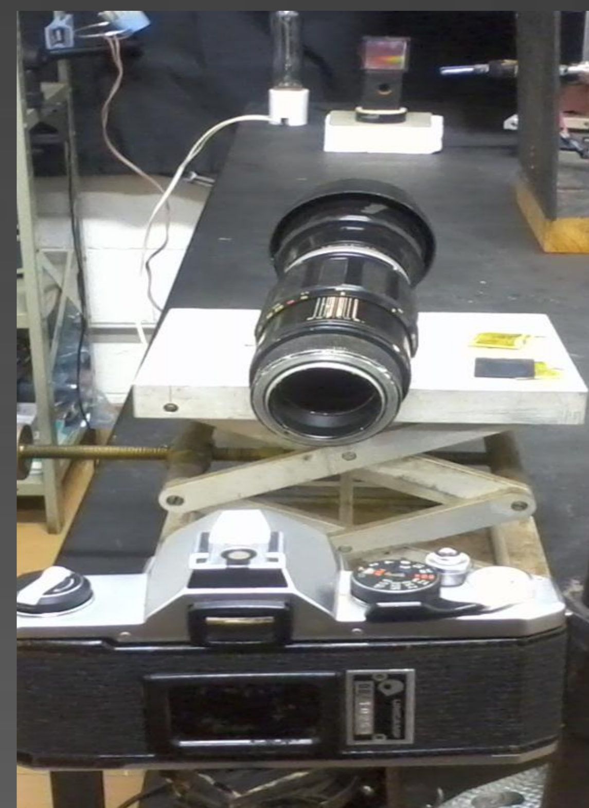
Figura 03: Sistema para gravar a holoimagem.
