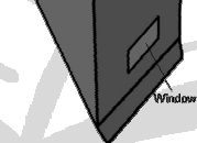
Figura 2: Máscara onde a membrana é colocada para então ser introduzida na janela da esfera de integração para a realização das leituras.
