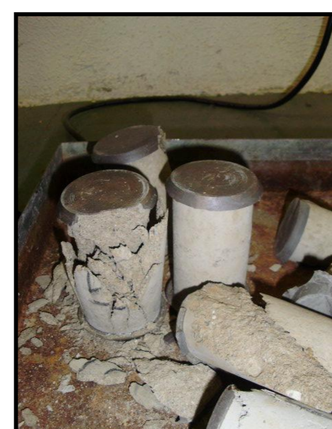
Figura 7. Corpos-de-prova rompidos. Fonte: Arquivo pessoal
