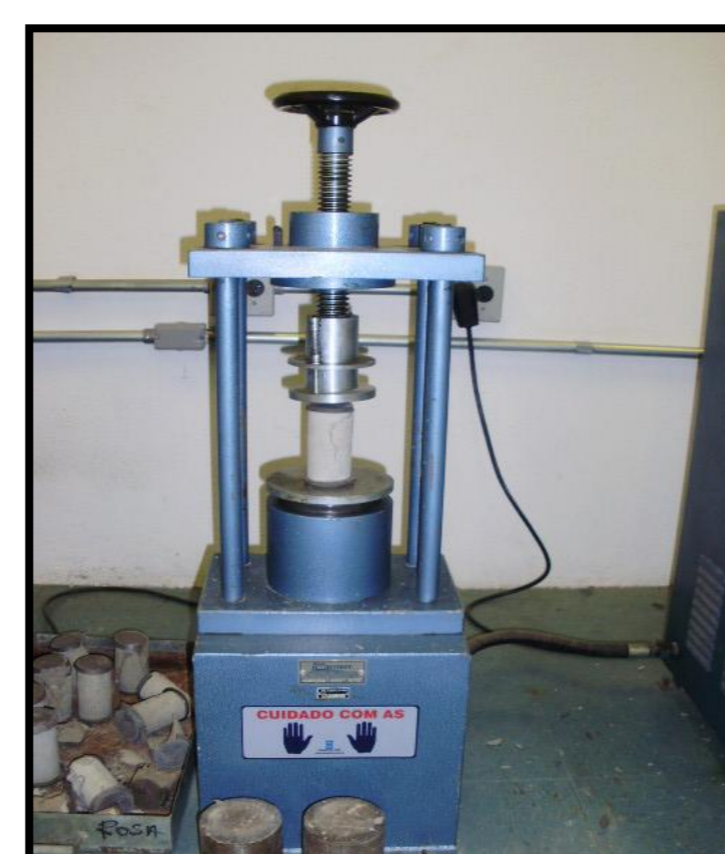
Figura 6. Teste de Resistência à compressão Fonte: Arquivo pessoal
