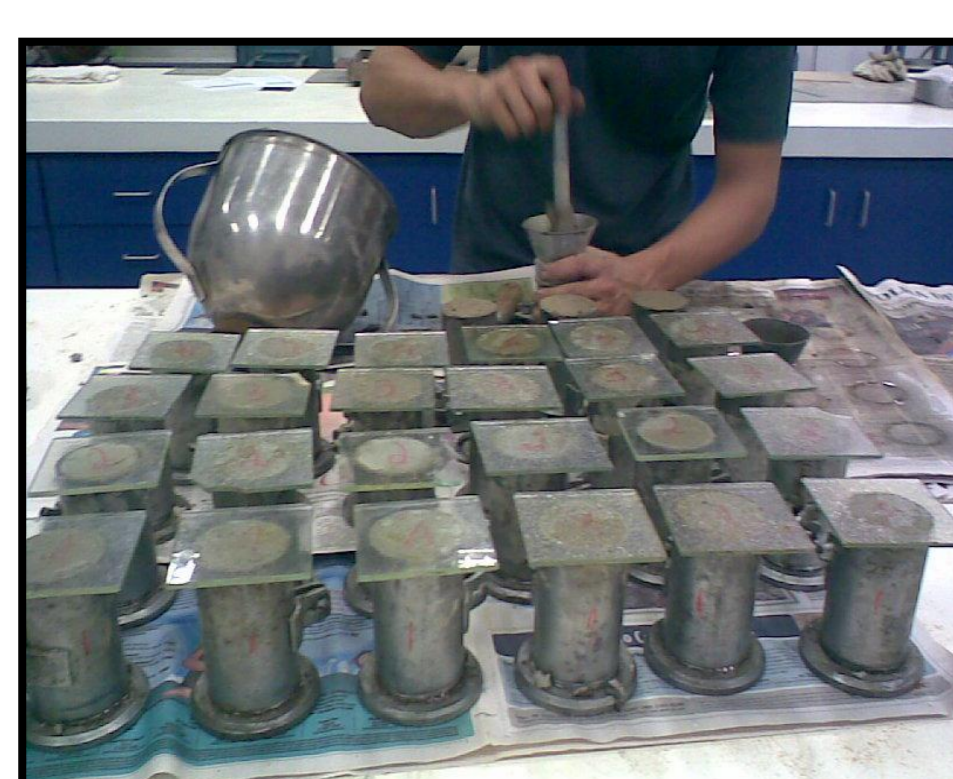
Figura 4. Moldagem dos corpos-de-prova. Fonte: Arquivo pessoal
