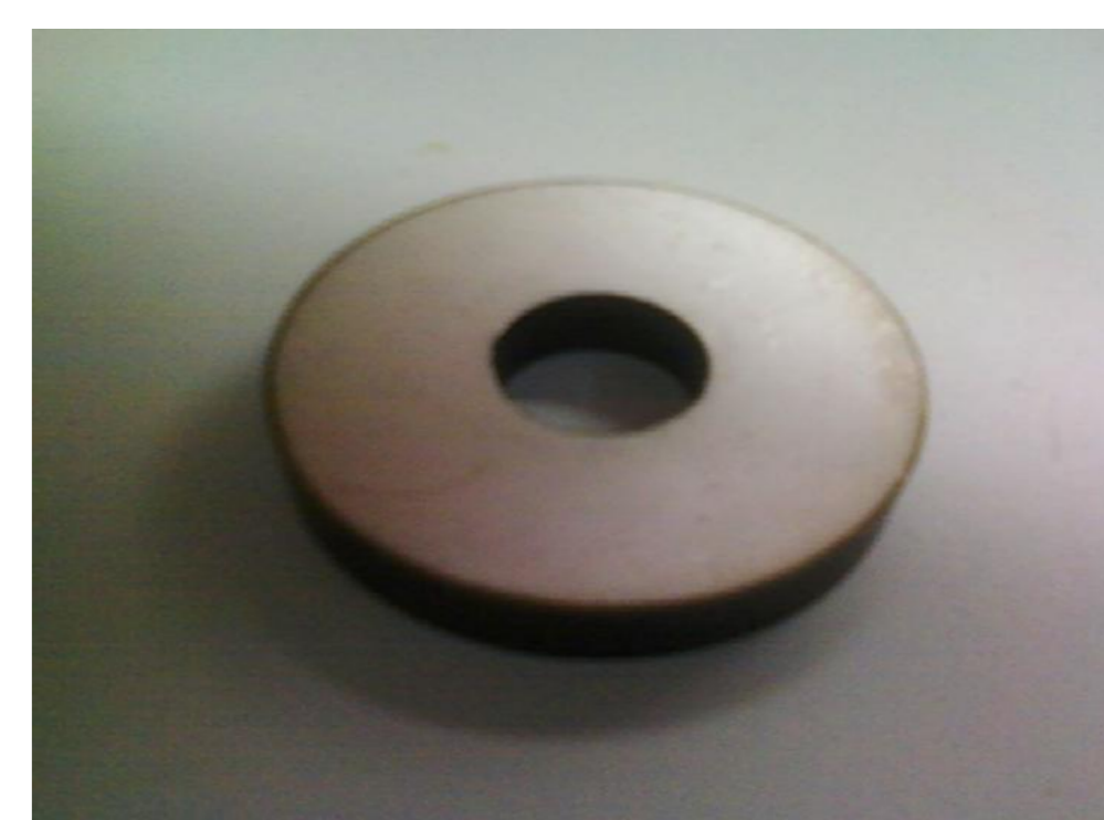
Figura7: Transdutor 2; Diâmetro interno: 12,6mm; Diâmetro externo: 38mm; Comprimento da lateral: 6,3mm.
