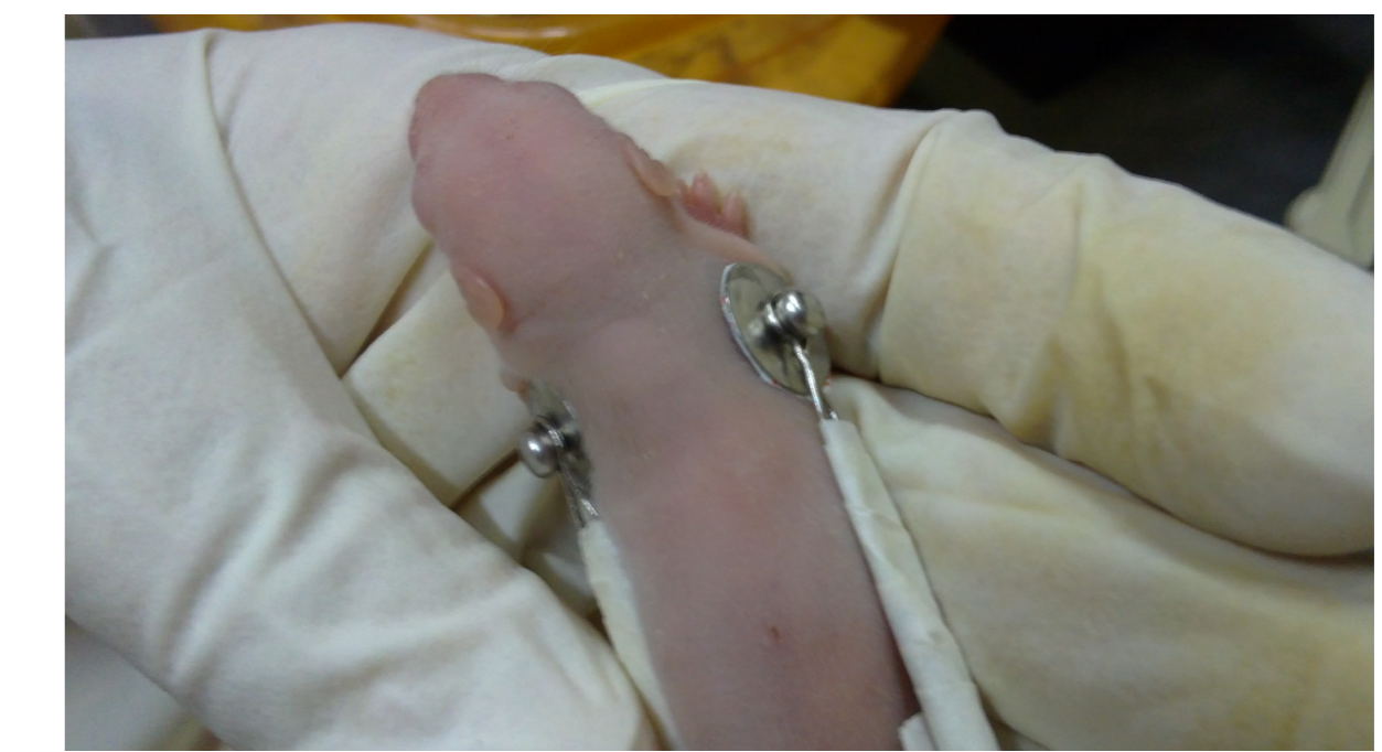
Figura 5 – Eletrodos para medição de eletrocardiograma em rato neonato. Cabo blindado com acoplamento em aço e eletrodo.
