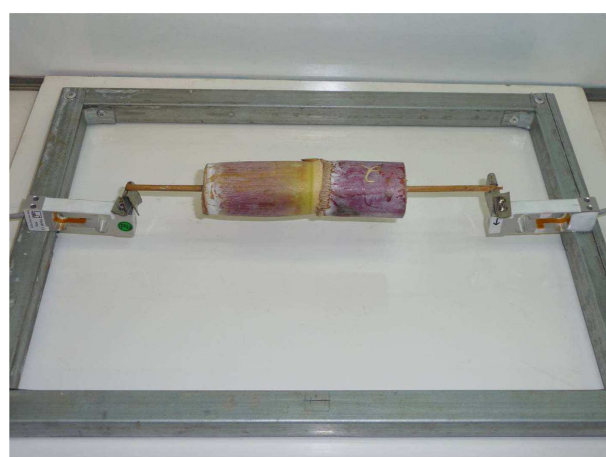
Figura 1. Suporte a ser acoplado sobre a saída do ventilador instrumentado com as células de carga.
