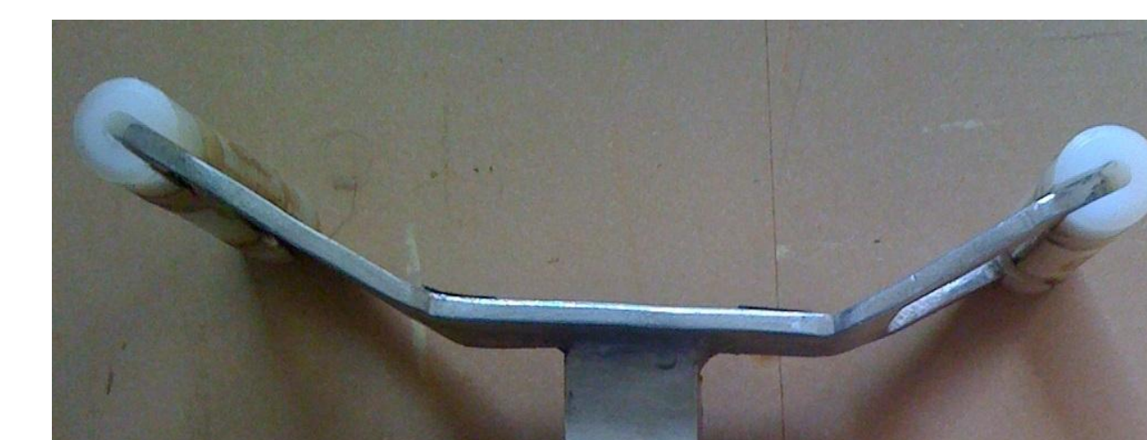
Manopla da haste TDR produzida no Laboratório de Protótipos da FEAGRI
