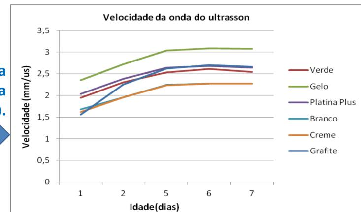
Velocidade da onda ultrassônica para cada idade de cura (prismáticos).
