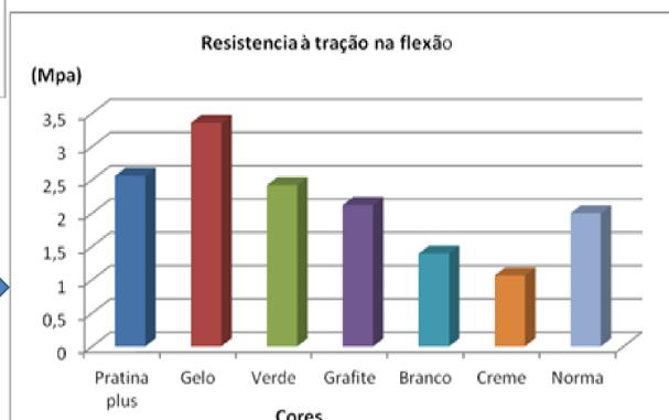
Ensaio de resistência à tração na flexão.
