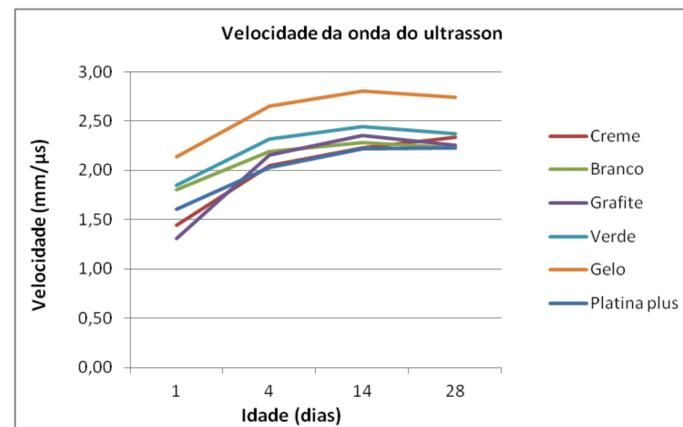
Velocidade da onda ultrassônica para cada idade de cura (cilíndricos).
