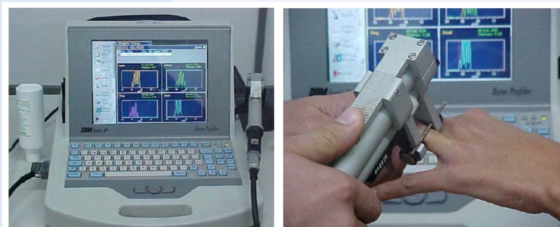
Figura 1: Equipamento DBM Sonic BP, IGEA, de 3ª geração, e posicionamento da mão para avaliação.
