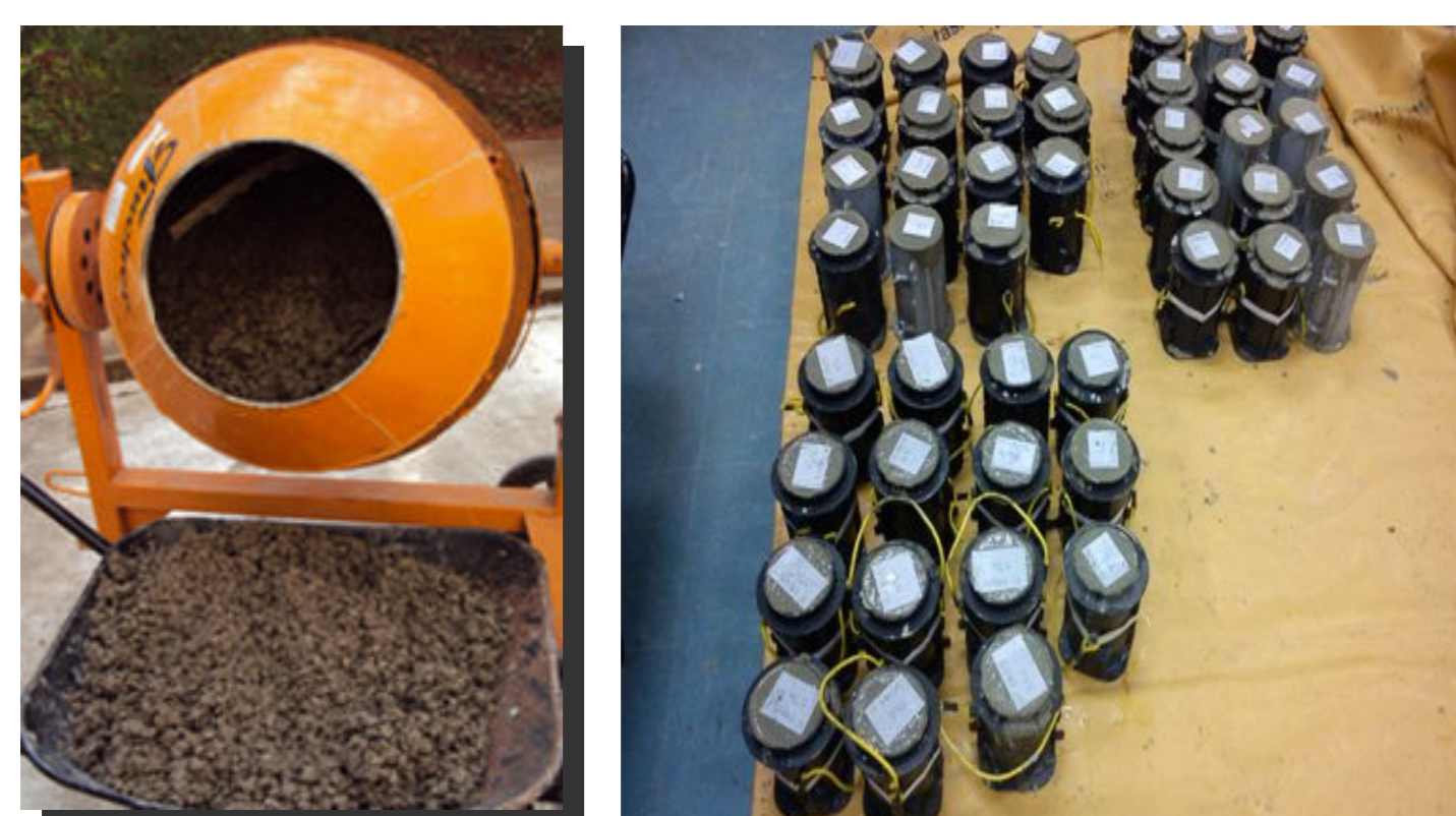
Figura 1: Produção dos corpos-de-prova cilíndricos
