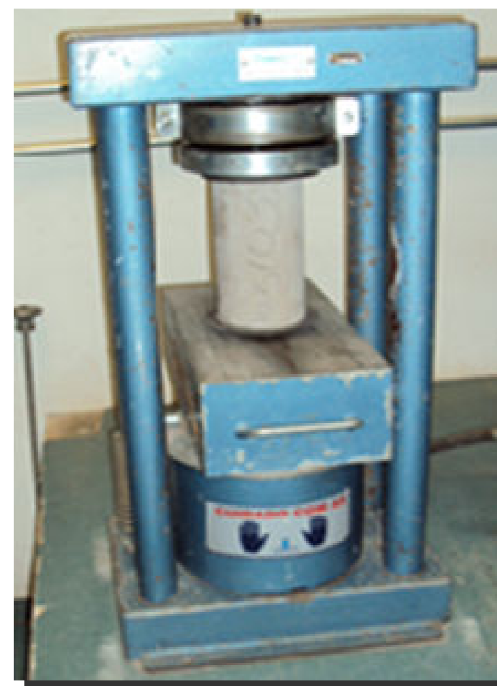
Figura 2: Ensaio de resistência à compressão
